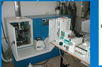
Σχήμα 4: Σύνδεση χρωματογραφικού συστήματος HPLC με ICP-AES
