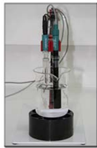
ISE – Cu Συνδυασμός εκλεκτικού ηλεκτροδίου χαλκού και ηλεκτροδίου αναφοράς (Metrohm)
