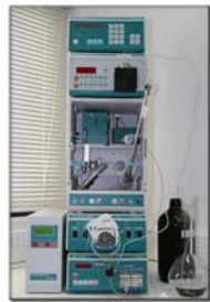
ISE – Cu Συνδυασμός εκλεκτικού ηλεκτροδίου χαλκού και ηλεκτροδίου αναφοράς (Metrohm)
